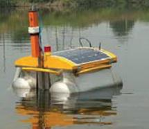
Sensor óptico sin contacto y autónomo para detección rápida de contaminación por aceite - método de fluorescencia UV.
